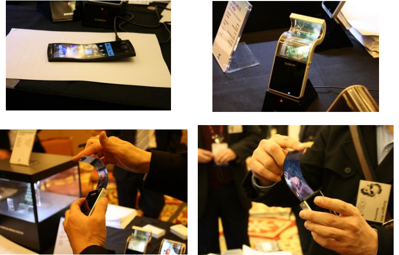
4.5吋Flexible AMOLED 解析度：WVGA 800x480 亮度：300cd/m 2 厚度：0.27mm Bending Radius <10mm
